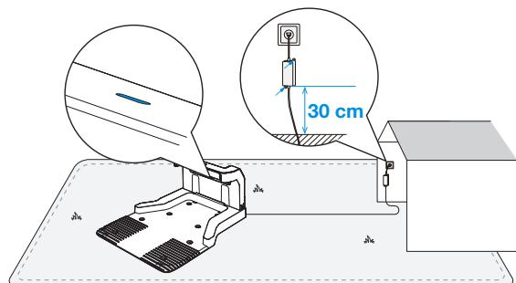
**Poznámka:** Ujistěte se, že je napájecí adaptér umístěn 30 cm nad zemí, aby se zabránilo poškození vodou a vlhkostí.
