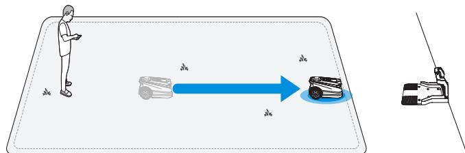
**Poznámka:** Pro zajištění úspěšného dobití se doporučuje udržovat základní stanici ve vzdálenosti do 3 metrů od trávníku a ne více než 10 metrů.
