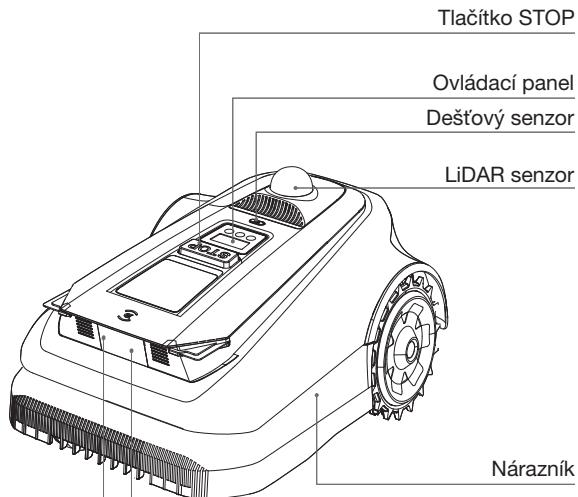
**Ovládací panel:** Tlačítka na ovládacím panelu lze použít pro základní ovládání sekačky. Digitální čísla na displeji přístrojové desky ukazují průběh sečení, stav baterie a stav sekačky.
