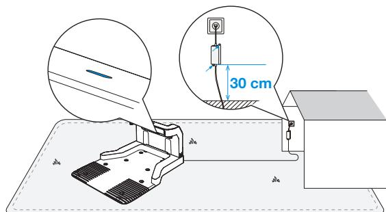
**Poznámka:** Uistite sa, že je napájací adaptér umiestnený 30 cm nad zemou, aby sa zabránilo poškodeniu vodou a vlhkostou.
